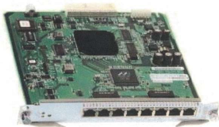
Рис. 4 Модуль розширення 3COM 3C16828 SWITCH 4005 8 PORT 10 / 100BASE-TX
