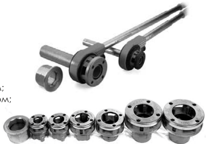
Мал. 23. Клупп для нарізування різьби на трубах
