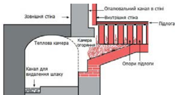
Рис.4 Система опалення «гіпокауст» часів Римської Імперії
