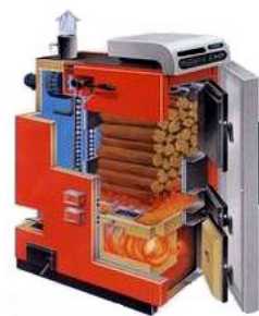
Рис.78 Котел з чавунним теплообмінником
