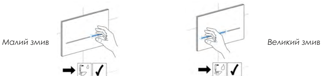
Рис. 49 - Функція подвійного змивання в безконтактній клавіші
