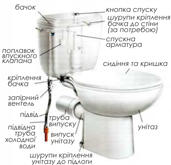
Рис. 42 - Конструкція унітазу
