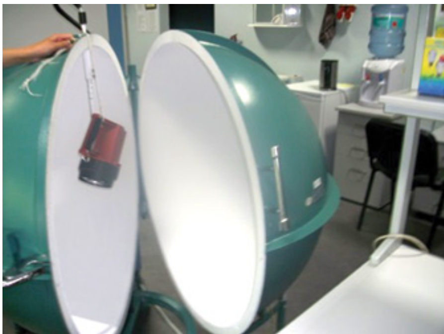
Рис. 5. Зовнішній вигляд розміщення ліхтаря VULCAN® LED усередині фотометричної сфери
