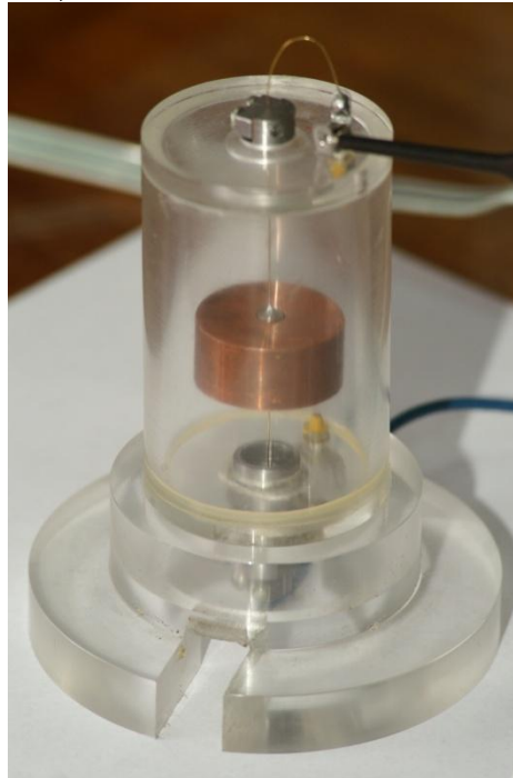
Рис. 1. Струнний гравіметр: зовнішній вигляд
