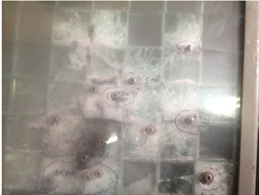
Рис. 1 Зовнішній вигляд балістичної панелі після обстрілу кулями різного калібру та типу
