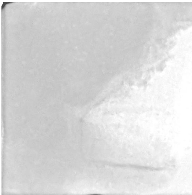
Рис 4. —Рентгенівська дефекограма захистної пластини з карбіду кремнію.
