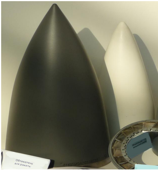
Рисунок - Приклад конструкції головного радіопрозорого обтічника авіаційної ракети
