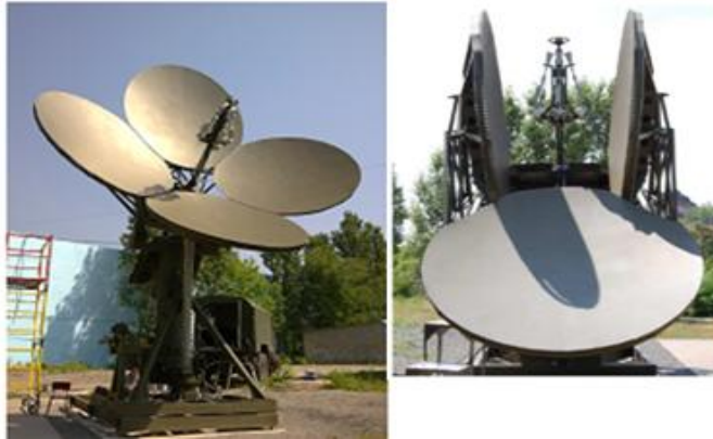
Рисунок 2 – Мобільна антенна система моніторингу Ka – band ШСЗ.
