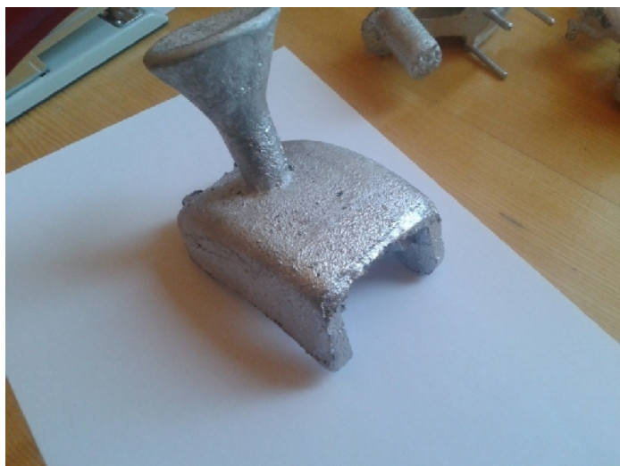
Рис.15-18. Модель и отливка “Рычаг-2”
