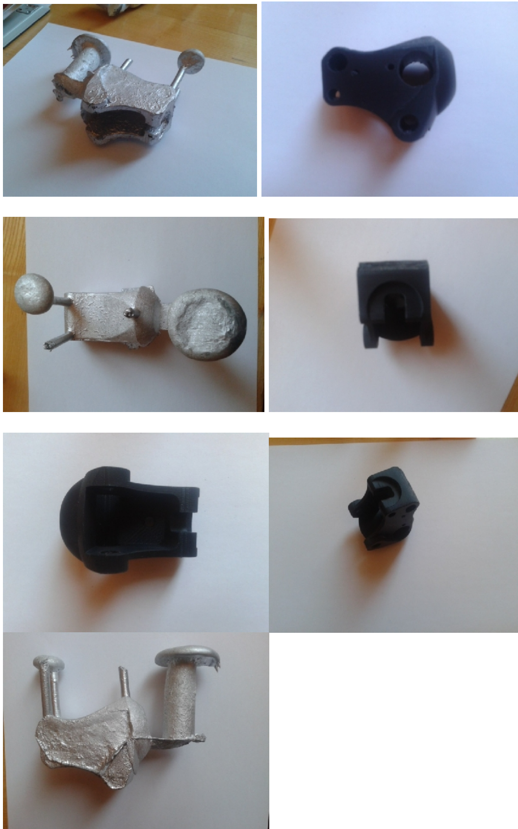
Рис.1-7. Модель и отливка “Нижний шарнир”
