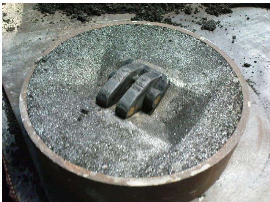
Рис. 23-24. Модель и разовая песчано-глинистая форма для детали “Колено”
