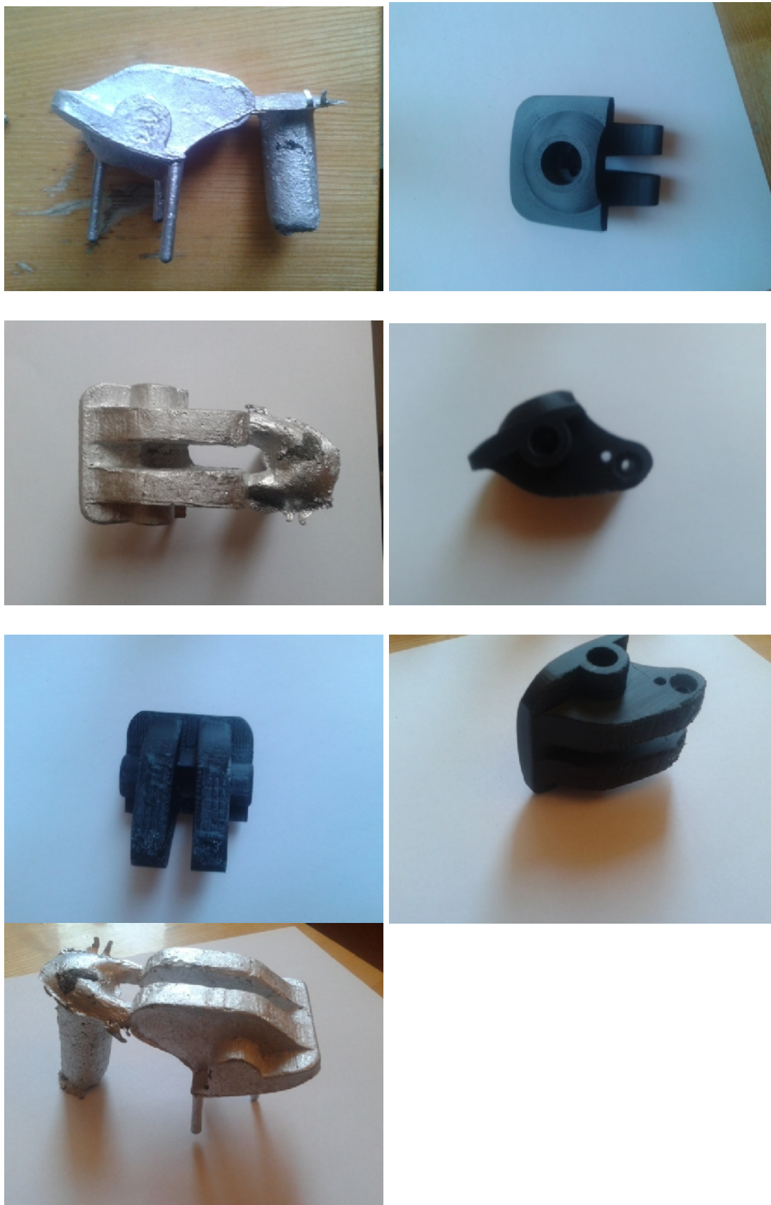
Рис.8-14.Модель и отливка “Колено”
