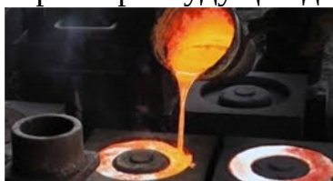
Рисунок 1 – Заливки жидкого металла в полость формы, для изготовления детали «Колесо»
