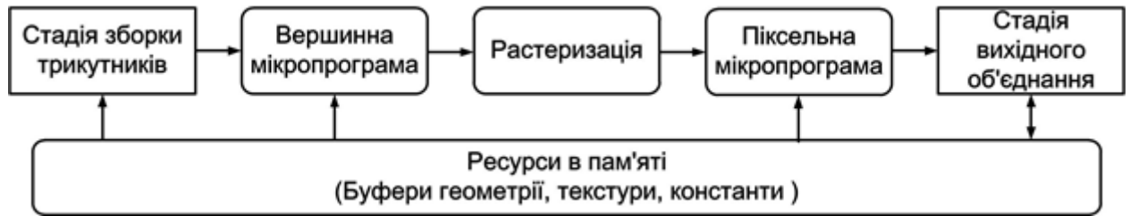
Ріс.1. Типова схема графічного конвеєру
