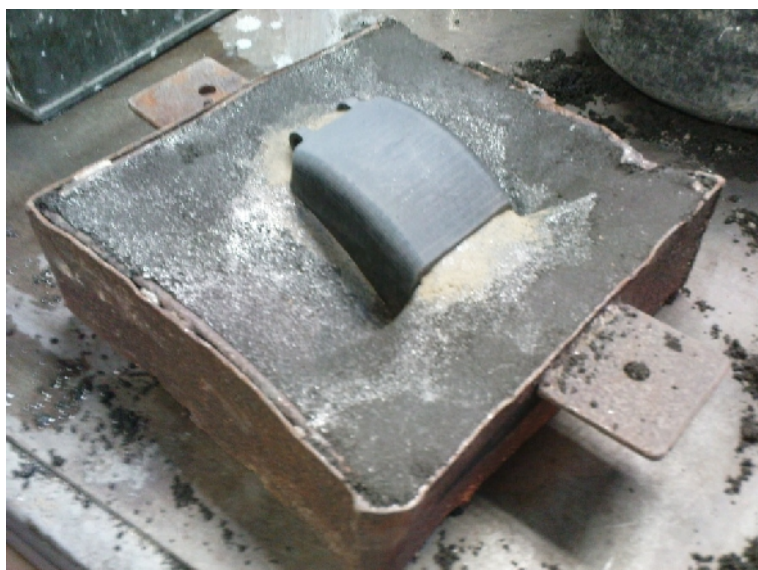
Рис. 19-22. Модель и разовая песчано-глинистая форма для детали “ Рычаг-2”
