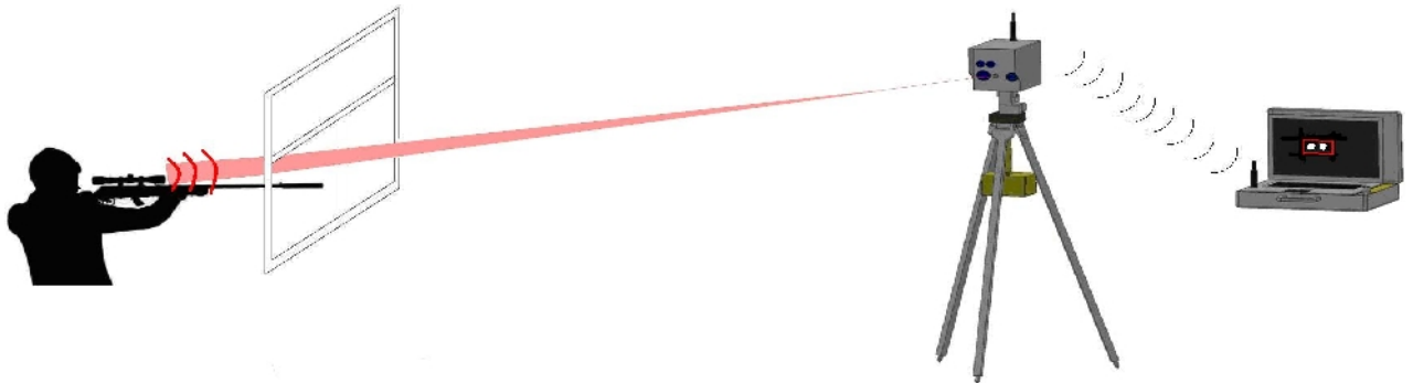
Рис.1. Принцип действия лазерной системы обнаружения снайперов
