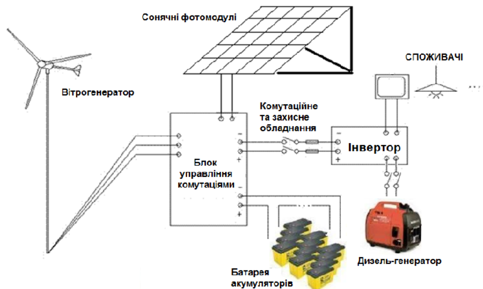
Рис. 2. Функціональна схема мобільної енергостанції
