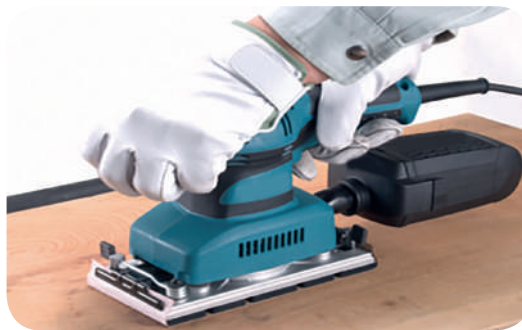
Рис. 7.38. Очищення дерев'яної поверхні за допомогою шліфувальної машини
