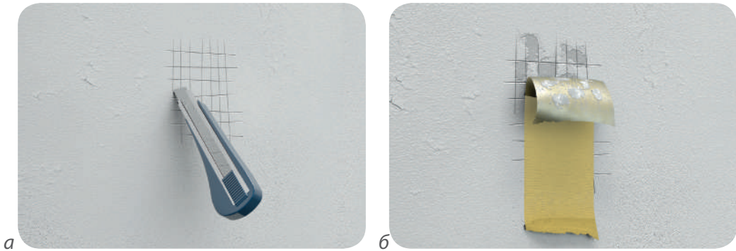
Рис. 7.6. Перевірка адгезії старого покриття методом «сітчастих надрізів»: а – виконання надрізів; б – відривання малярної стрічки
