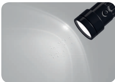
Рис. 7.22. Перевірка якості роботи за допомогою ліхтарика
