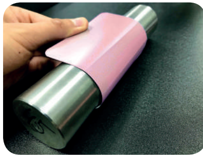
Рис. 2.3. Визначення еластичності лакофарбового покриття
