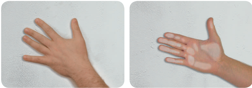
Рис. 7.5. Перевірка міцності поверхні долонею
