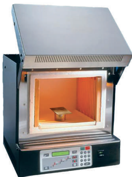
Рис. 2.8. Визначення термостійкості лакофарбового покриття
