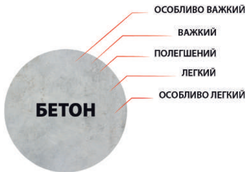
Рис. 5.3. Класифікація бетону за ступенем щільності
