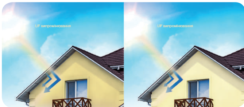
Рис. 2.7. Вигорання кольору лакофарбового покриття на фасаді будинку під впливом світла
