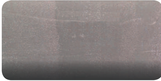
Рис. 7.46. Дефекти фарбування – смуги
