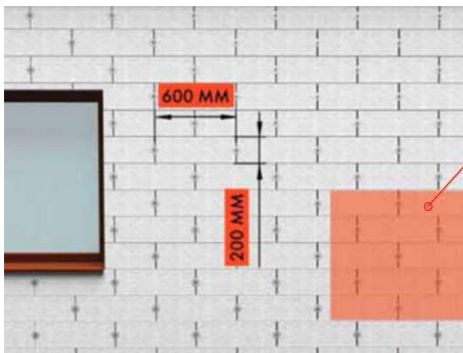
Схема розміщення дюбелів у звичайній зоні: 6 дюбелів на 1 м 2
