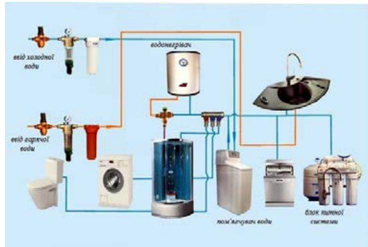
Рис. 49 Схема очищення води в квартирі
