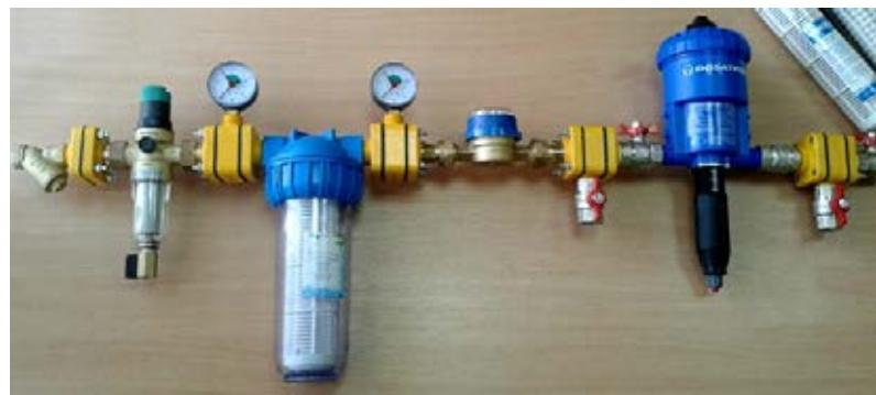
Рис. 48 Монтаж фільтрів у системі водопостачання
