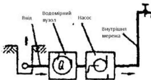
Рис. 16 Схема з обладнанням для підвищення тиску
