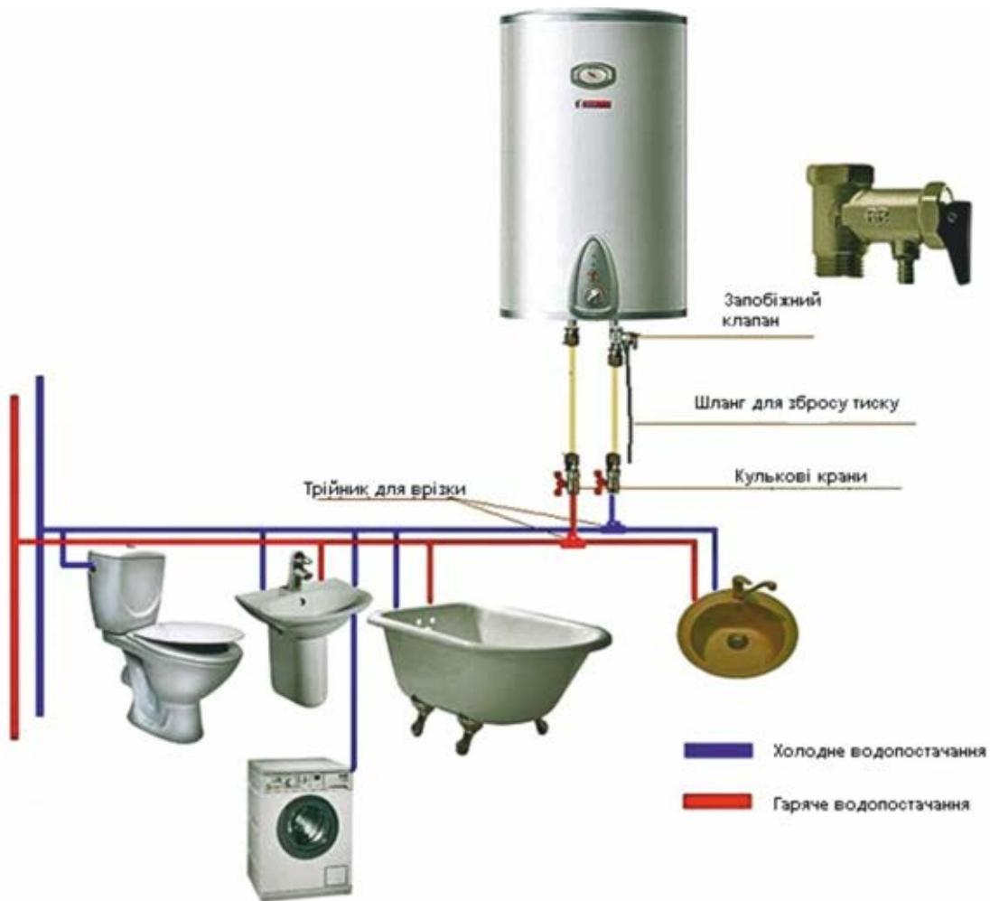
Рис. 92 Схема підключення гарячої та холодної води в квартирі
