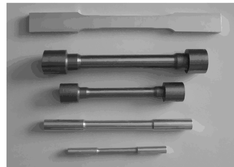
Рис. 3. Зразки для випробувань на розтягування
