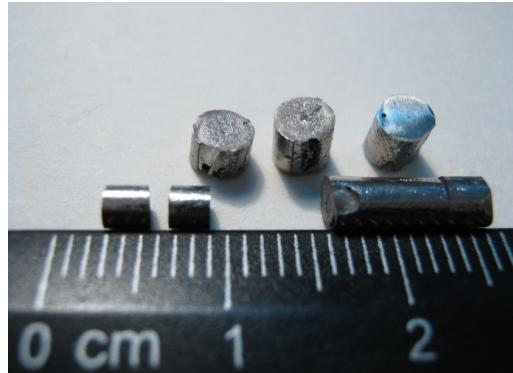
Зразки стрічкових та об'ємних аморфних металевих сплавів
