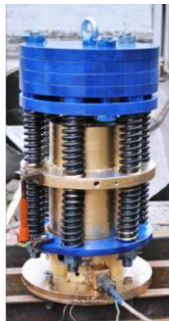
Віброзанурювач на основі коаксіально-лінійного двигуна з постійними магнітами
