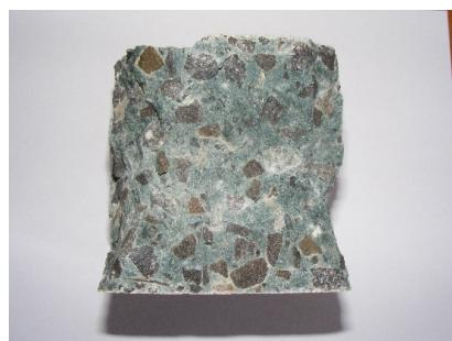
Руйнування заповнювача після випробування бетону
