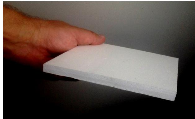
Зовнішній вигляд прототипу негорючого теплозахисного покриття товщиною 11 мм
