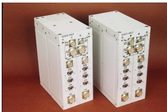
Апаратура обробки сигналів для багатоспектральних сканерів
