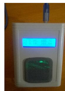
Зовнішній вигляд частотного вимірювача концентрації пилу
