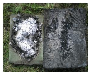
Випробування модельного зразка тари, обробленого захисним покриттям, при дії полум'я магнію
