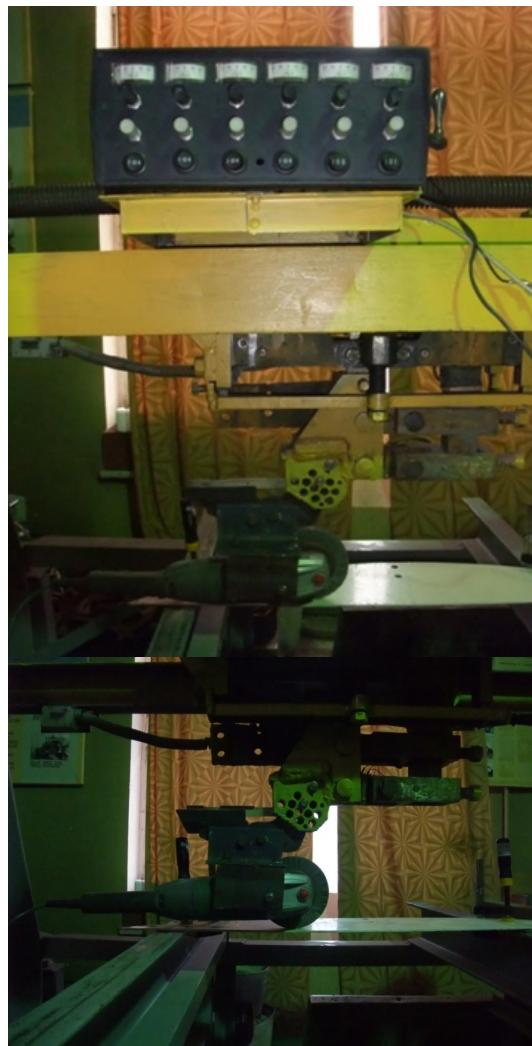
Робоче обладнання, закріплене на стенді для вимірювання сили очищенння поверхонь
