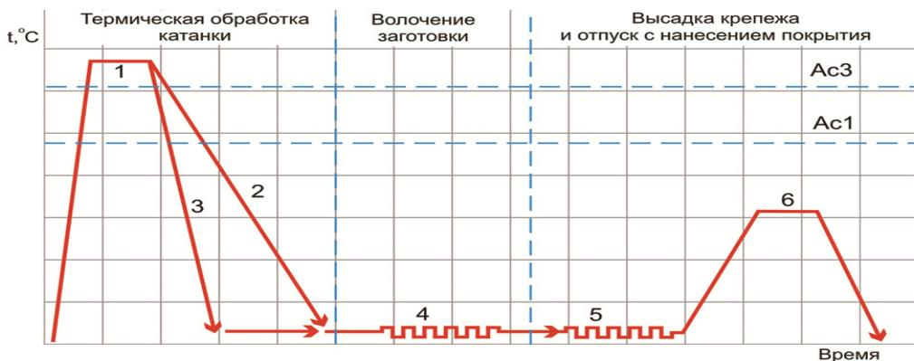
Схема технології виробництва високоміцніх кріпильних виробів
